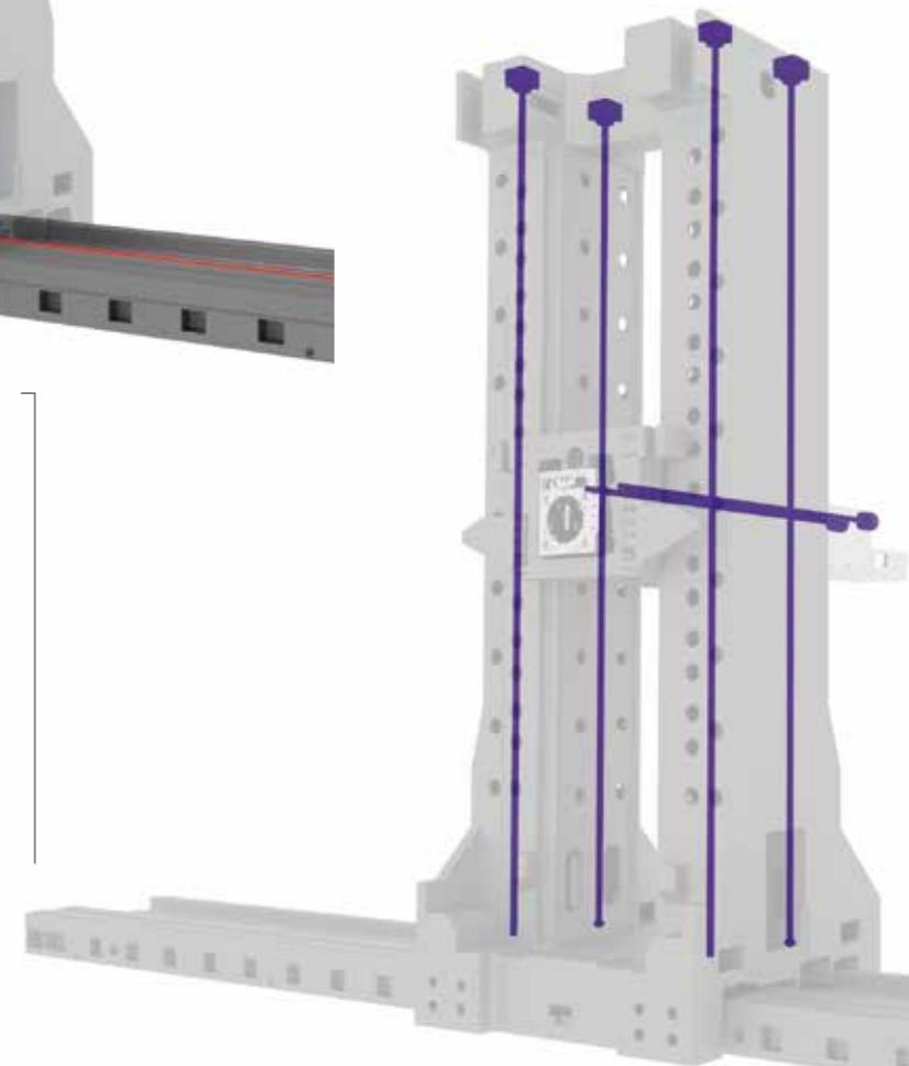
Movimento verticale eseguito con doppia trasmissione e con sistema di bilanciamento dotato di doppio dispositivo, il tutto completamente simmetrico.
